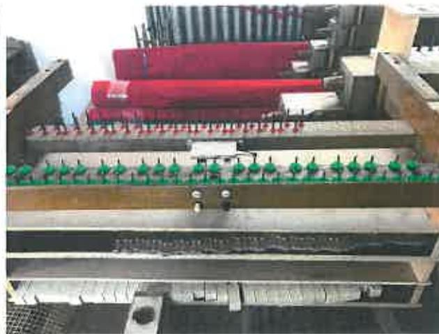
Neue Führungsstifte für die Tasten wurden eingebaut
